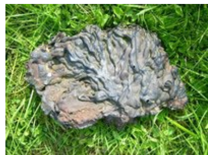
Abb. 2 Erkalte Schlacke aus einem Ofen zur Eisenverhüttung nach antiker Art.
