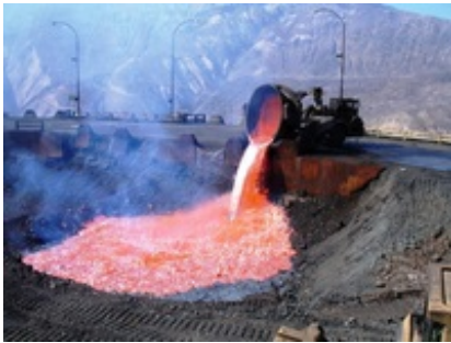
Abb. 1 Abkippen von flüssiger Schlacke im modernen Verhüttungsprozess.
